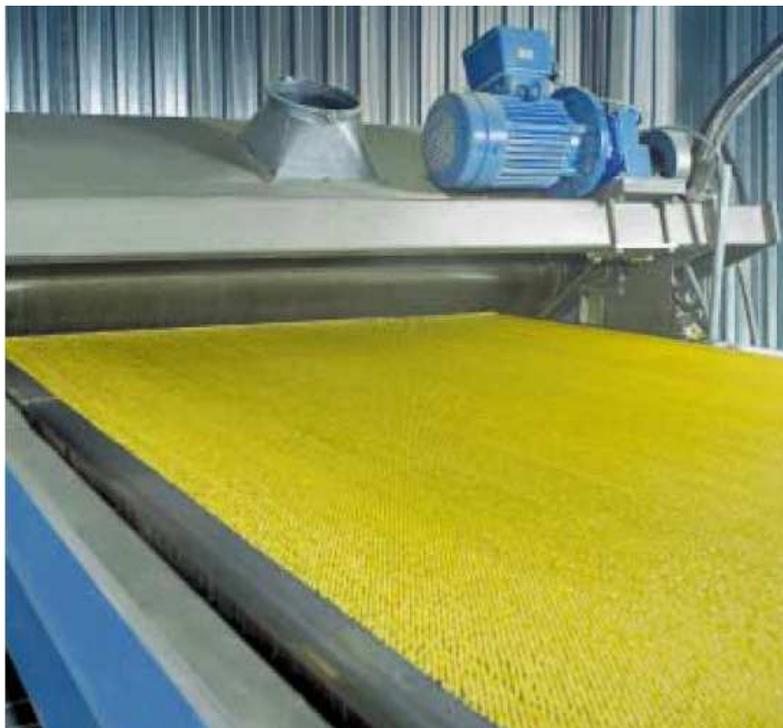
Rotoform HS – подача капель серы на стальную ленту конвейера-охладителя
