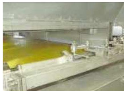
Секция охлаждения узла Rotoform
