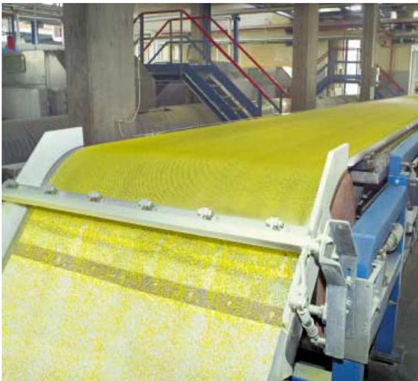
Установка Rotoform – разгрузочный узел
